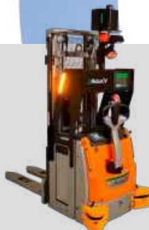
Robosc. Интеллектуальный роботизированный штабелёр для складского пользования.
