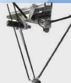
Nevlabs. Дельта-робот сортировщик мусора.
